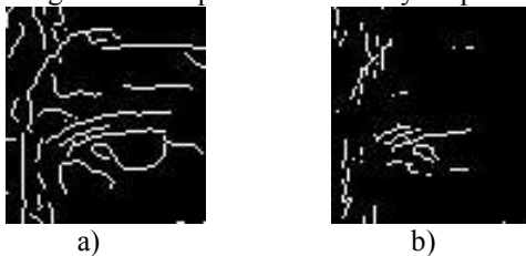
Fig. 10. Eye edge diagram using a) canny edge detector and b) sobel edge detector.
